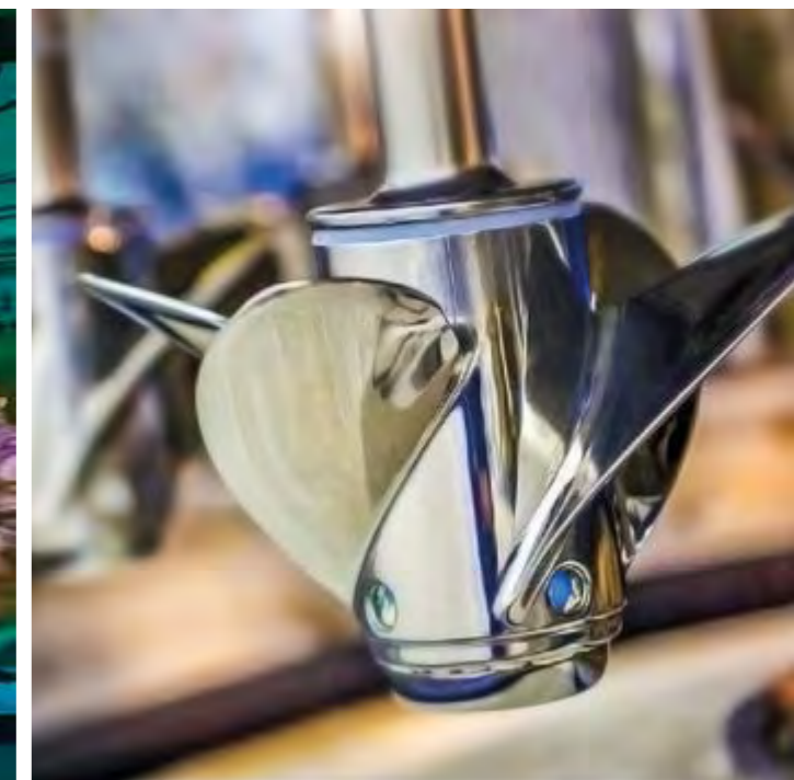
Da sinistra, la forma dell'elica prima che sia porcellanata; l'estrazione del "mestolo" con l'acciaio fuso; il riempimento della forma in ceramica; l'elica finita dopo la lucidatura.
